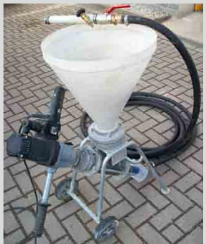
Schneckenpumpe u. a. für Bitumendickbeschichtung
